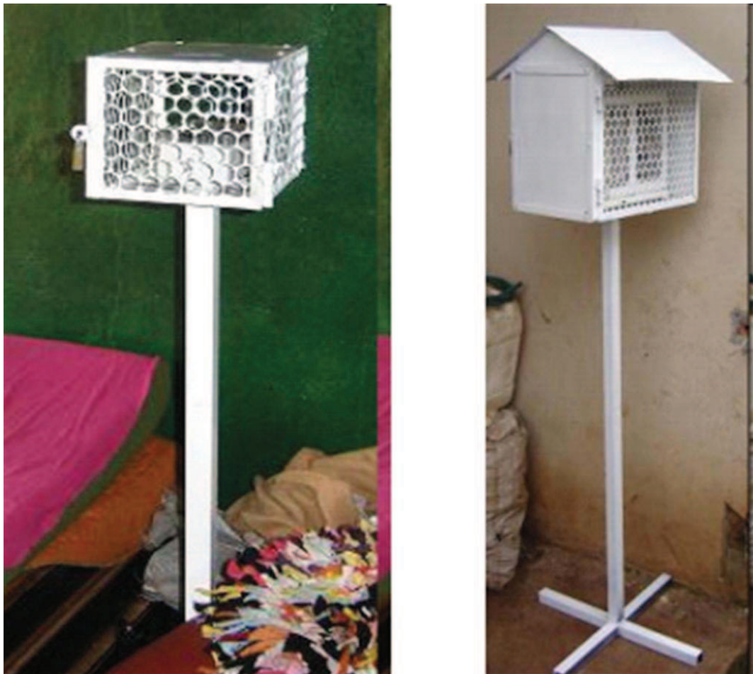
Figura 10 - Abrigos interno e externo para proteção dos equipamentos
