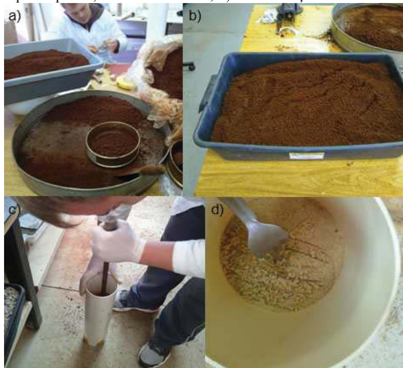
Figura 13: Peneiramento do solo e moldagem dos copos de prova. a) Peneiramento do solo, com peneira n°4; b) solo peneirado condicionado em bandejas; c) moldagem por camadas no corpo de prova, utilizando estaca; d) escarificação do solo a cada camada.
