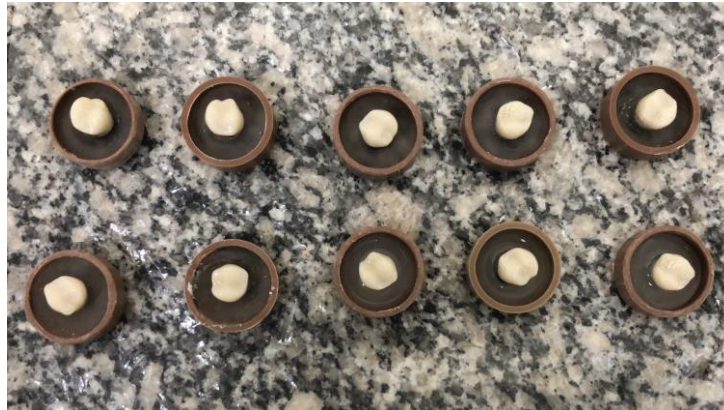
Figura 11. Amostras incluídas em anel de PVC preenchido com resina acrílica autopolimerizável.
