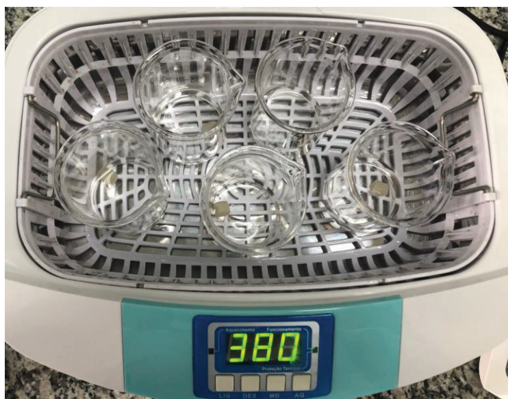
Figura 5. Limpeza em cuba ultrassônica com álcool e água destilada.
