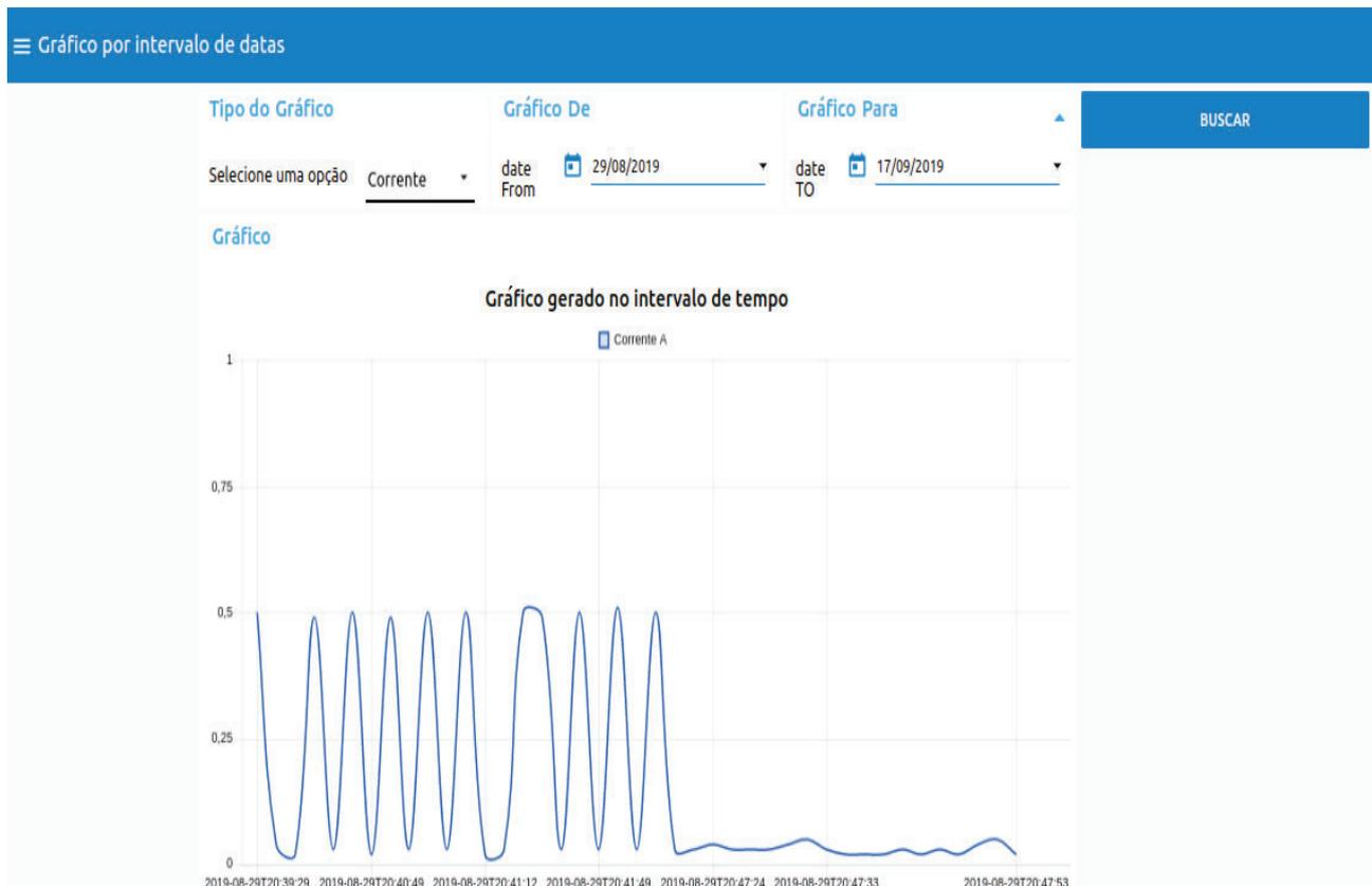
Figura 22. Gráfico de corrente por intervalo de tempo, baseado em dados enviados pelo protótipo.
