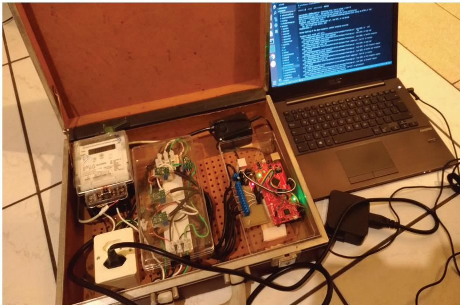
Figura 14. Protótipo de monitoramento de energia elétrica com o serviço de recebimento dos eventos.
