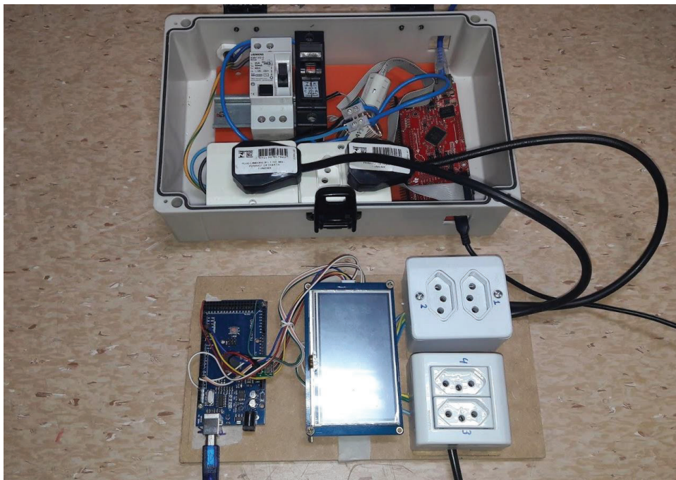
Figura 8: Circuito criado para acionamento das cargas. Os relés estão sob o display .
