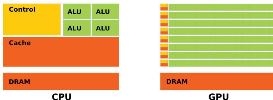
Figura 3. Diferença de arquitetura entre CPU (à esquerda) e GPU (à direita) [20].
