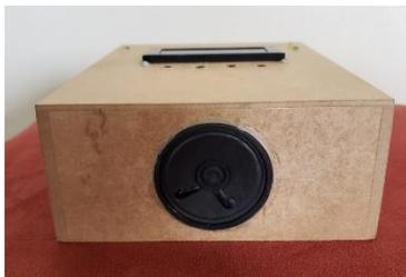
Foto 6: Autofalante com a função de caixa de ressonância<sup>103</sup>
