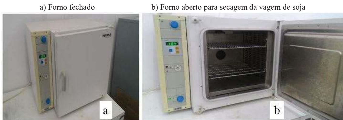
Figura 21 - Forno para secagem de da vagem de soja verde e seus resíduos
