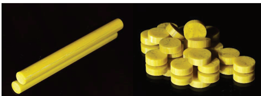
Figura 2 - Cilindro de CRFV após a usinagem em torno, com diâmetro de 12 mm, e bases de CRFV com 4mm de espessura.
