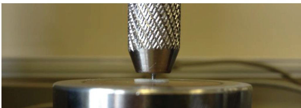
Figura 4: Disco de dentina sendo submetido ao teste de pushout.
