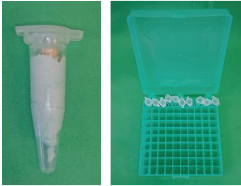
Figura 1: Raíz fixada com sílica pesada no interior de um eppendorf e caixa de polipropileno com amostras posicionadas.
