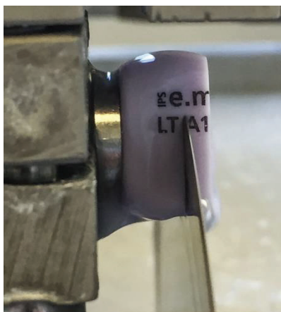
Figura 2. Cortadeira metalográfica com disco diamantado sob lubrificação sendo usada para fatiar os blocos de CAD-CAM, nesse caso um bloco de IPS e.max CAD.
