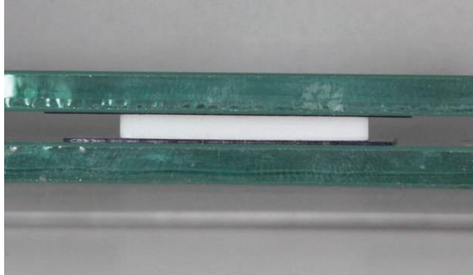
Figura 9. Visão lateral de montagem das placas de vidro, tiras de poliéster e matriz de teflon para a fabricação dos substratos.
