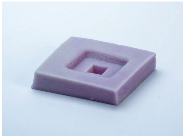
Figura 4. Matriz de silicone de condensação (Zetalabor) utilizada para auxiliar durante a aplicação da cerâmica de cobertura sobre a infraestrutura de zircônia.
