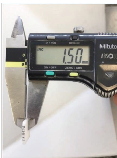
Figura 5. Aferição do CP (Enamic) após acabamento e polimento para verificação da espessura final (1,5 mm).
