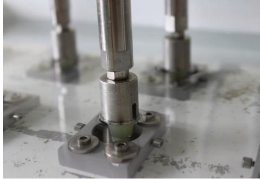
Figura 11. CP posicionado no interior do porta-amostras, com a ponta de G10 aplicando a carga cíclica através de um pistão pneumático, imerso em água a 37° C.
