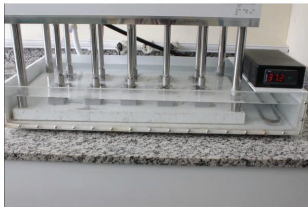
Figura 10. Máquina de ciclagem mecânica pneumática utilizada no ensaio de fadiga.
