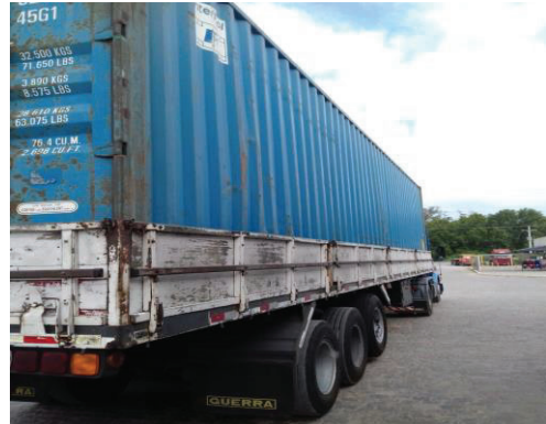
Figura 60: Container travado para ser transportado em caminhão truck.
