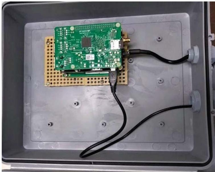
Figura 12. Gateway *multichannel* construído
