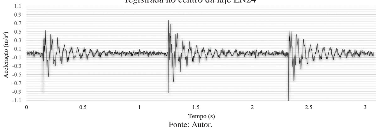
Figura 32 – Resposta da aceleração no tempo devida a repetição de três impactos dos calcanhares registrada no centro da laje LN24
