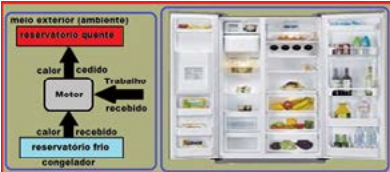
Figura 10 – Funcionamento de uma máquina frigorífica.
