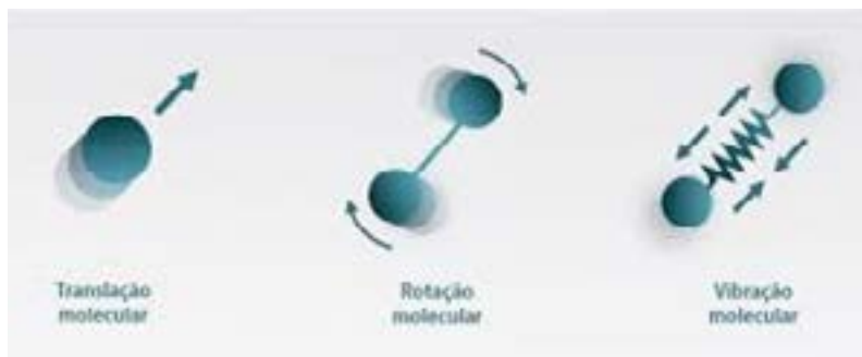
Figura 6 - Energia interna de um sistema
