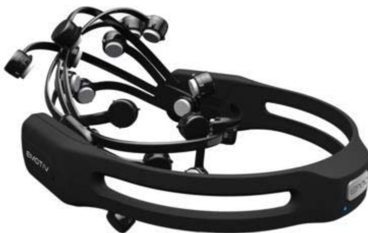
Figura 7 – Headset utilizado para registrar os sinais cerebrais e as expressões faciais dos usuários [42].
