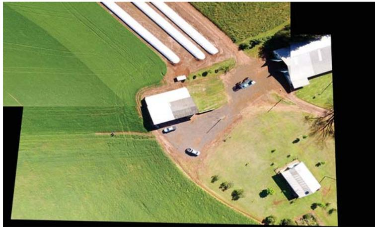
Figura 4. Mosaico de duas imagens utilizando a técnica de mosaico não controlado (Observa-se na parte superior esquerda da imagem, perto do galpão, que existe algumas falhas na sobreposição das duas imagens).
