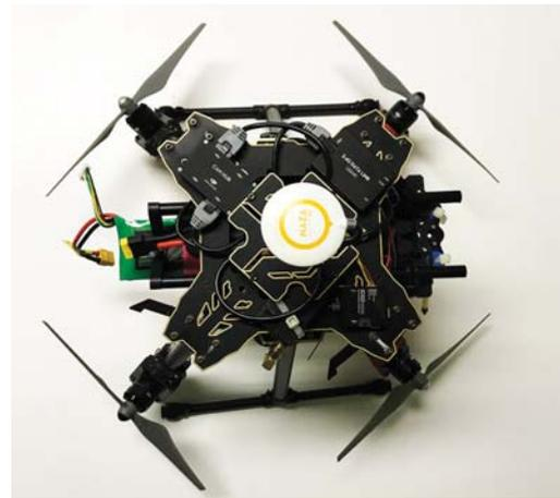
(b) Vista superior do Drone DJI DIY com os braços recolhidos. Este tipo de frame pode facilitar seu transporte.
