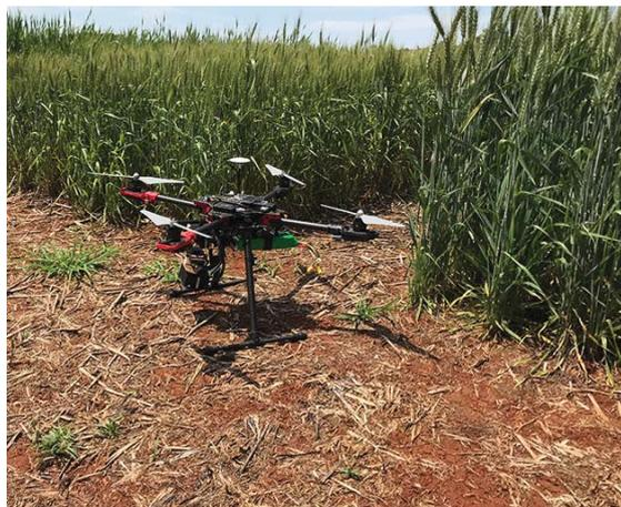
(a) Drone com a câmera TETRACAM acoplada utilizado para realizar as coletas.
