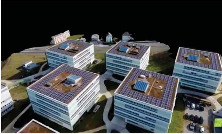
Figura 6. Modelo 3D do Terreno gerado pelo software PIX4Dmapper.
