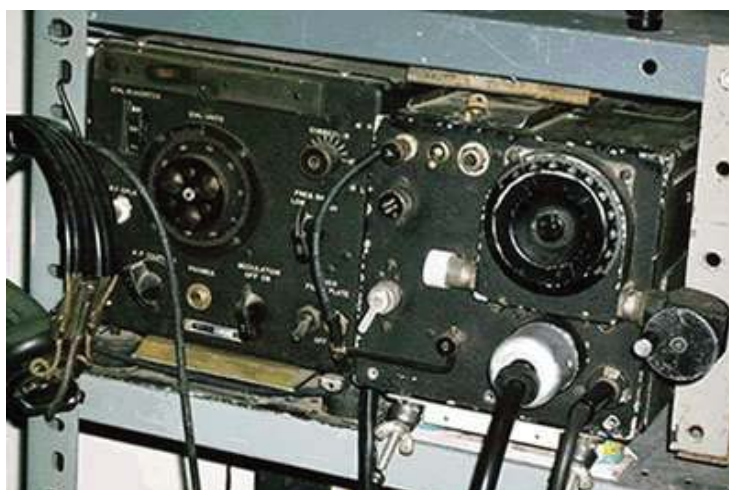
Figura 4.3 – Rádio receptor BC-AH-229 utilizado em aeronaves CATALINA, modelo utilizado pela FAB e US Navy durante a Segunda Guerra Mundial.
