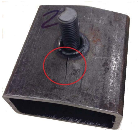
Figura 35 – Corpo de prova após fratura por fadiga
