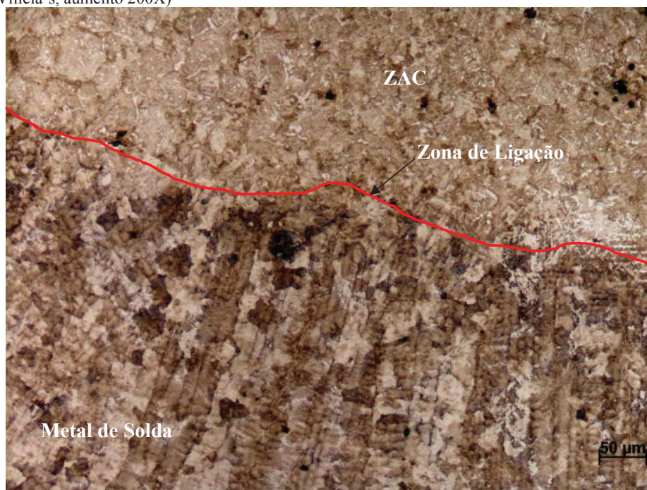
Figura 44 - Micrografia da zona de ligação entre o metal solda e ZAC da condição 4 do corpo de prova 4.2 (ataque Villela's, aumento 200X)
