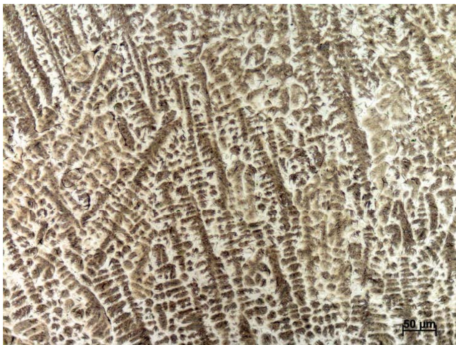
Figura 39 - Micrografia do metal de solda da condição 3 do corpo de prova 3.2. (ataque Villela's, aumento 200X)
