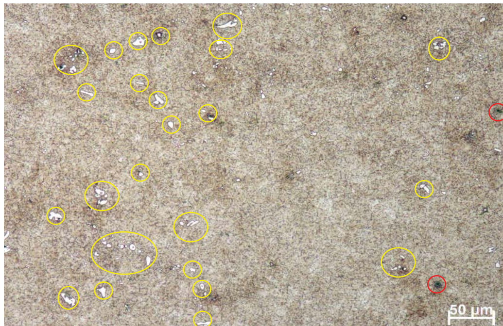
Figura 33 - Micrografia do material de base (ataque Vilela's, aumento 200X)
