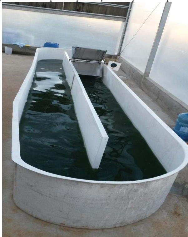
Figura 14: Tanque de produção de Spirulina platensis .
