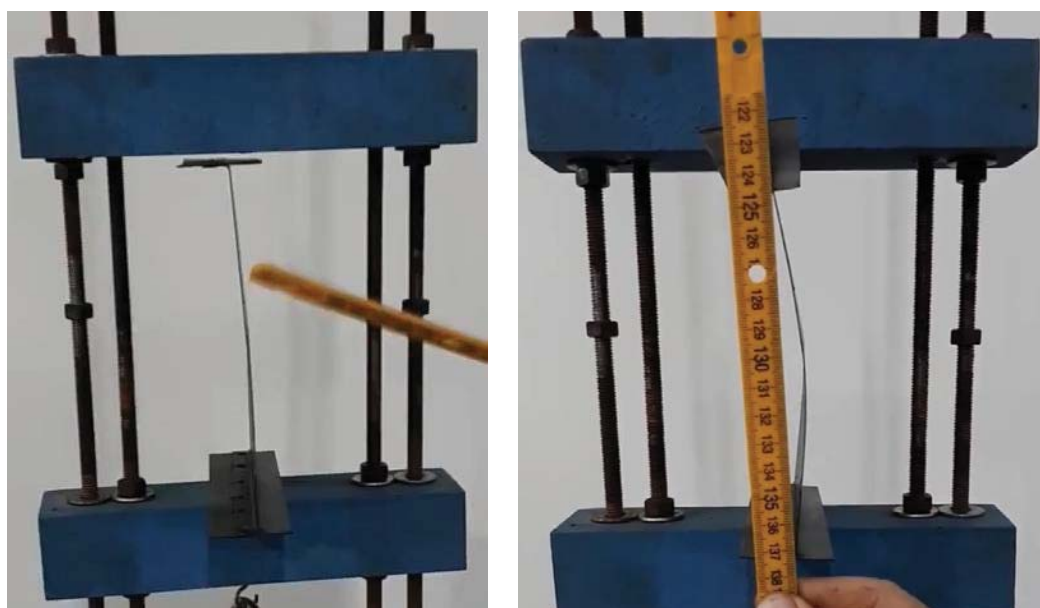
Figura 20-Ensaio viga sem enrijecedores 28.a e 28.b
