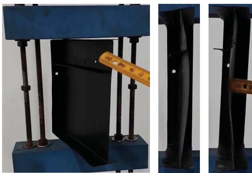
Figura 22-Viga com enrijecedor transversal e longitudinal, 30.a e 30.b painel fora do plano, 30.c imperfeição na alma .
