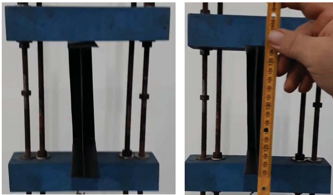
Figura 21- Viga com enrijecedor longitudinal. 29.a e 29.b.
