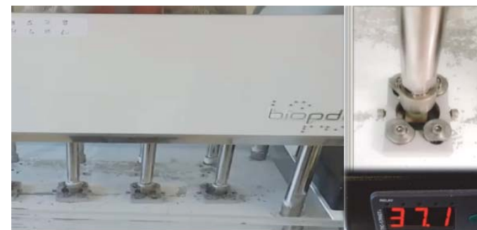
Figura 12. Teste de envelhecimento mecânico por ciclagem em água com temperatura de 37.1 °C.
