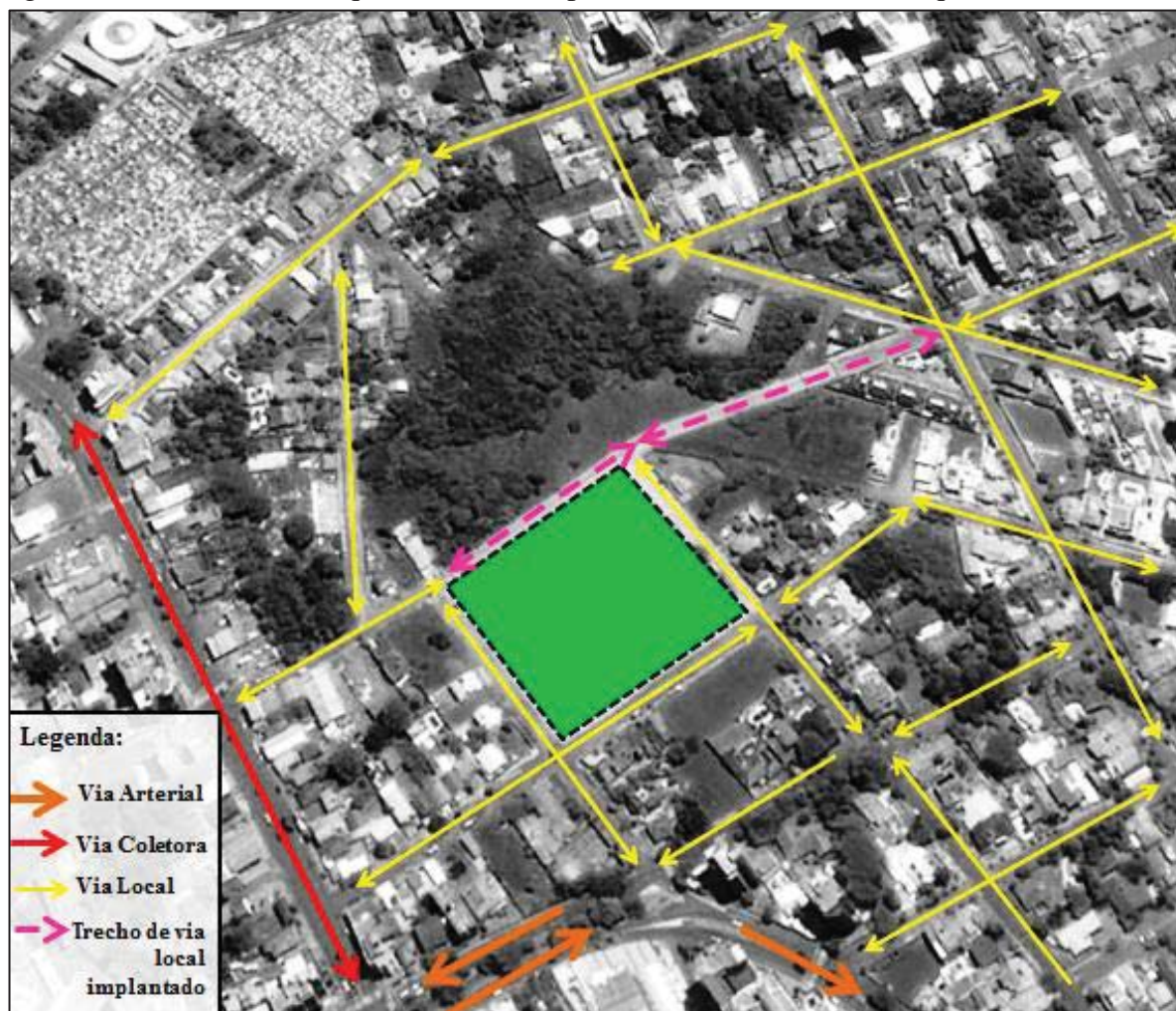
Figura 67 – Entorno do Parque do Banhado: parcelamento do solo, hierarquia e fluxos viários.
