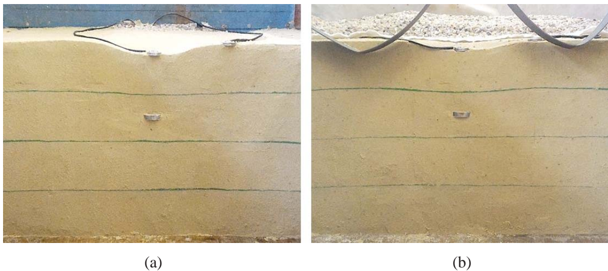
Figura 39: Exumação das camadas de areia subjacente a uma camada de 5 cm de resíduo (a) sem reforço SR-5, (b) com reforço GCE-5.
