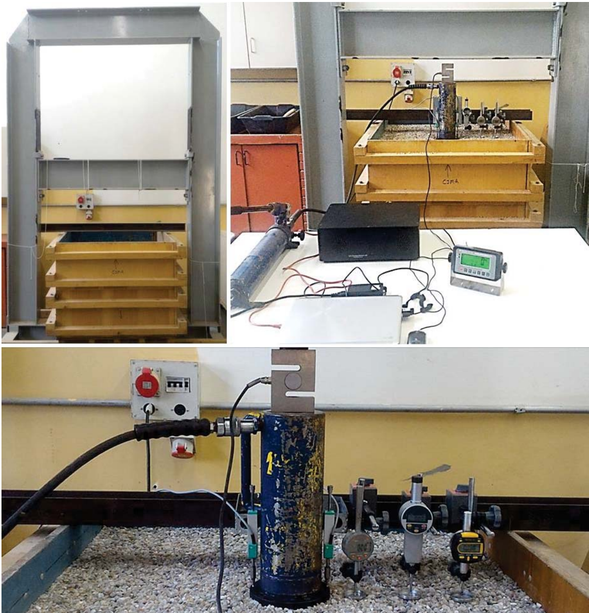
Figura 17: Configuração completa dos ensaios de placa.
