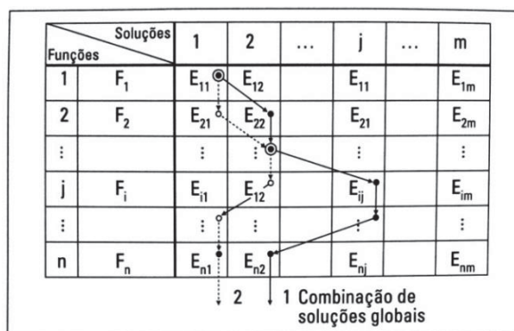
Figura 7 – Constituição básica de um esquema classificatório com subfunções de uma função global e suas respectivas soluções.
