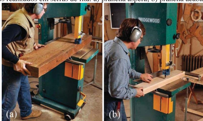
Figura 11 – Cortes retos realizados em serras de fita: a) prancha áspera; b) prancha acabada.
