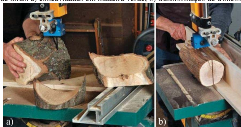
Figura 14 – Cortes de toras: a) concavidades em madeira verde; b) transformação de troncos em placas.
