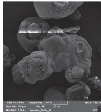
Figura 9 – Micrografia eletrônica da micropartícula definida para incorporar na massa fresca tipo talharim
