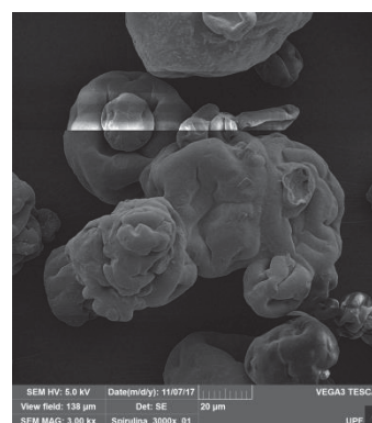
Figura 2 – Micrografia eletrônica da Spirulina e das esferas
