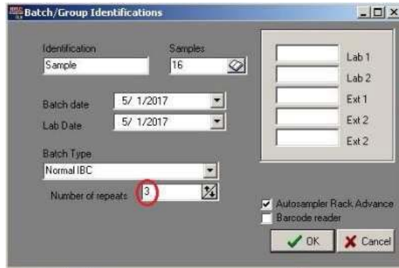
Figura 10 - Comando do software do equipamento que permite a leitura em triplicata
