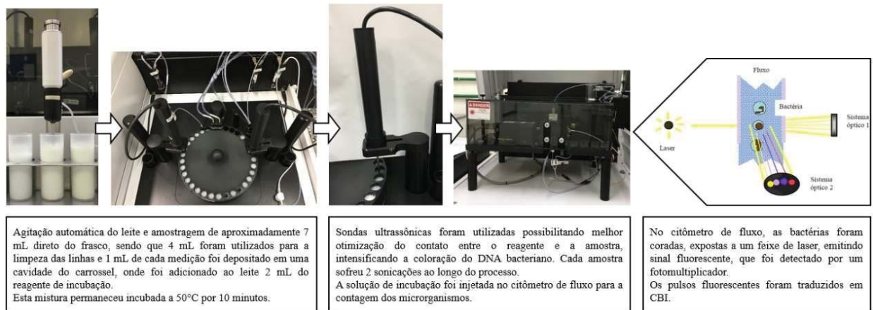
Figura 11 - Princípios de operação do citômetro de fluxo
