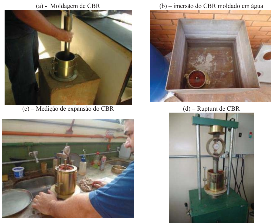
Figura 19: Ensaio de CBR
