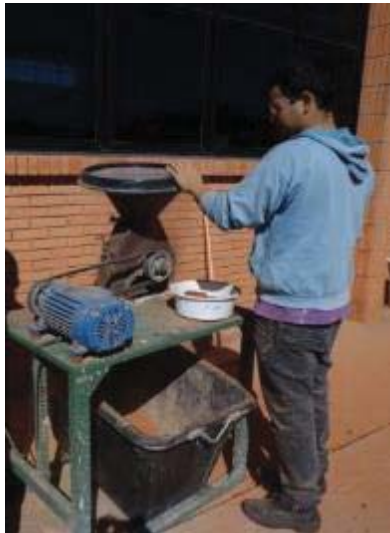
Figura 14: Equipamento para triturar o RCD e material pronto para os ensaios
