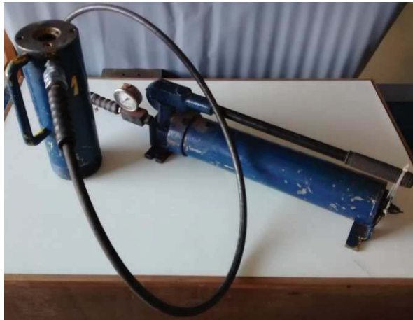
Figura 42 - Cilindro hidráulico para aplicação da carga de compressão
