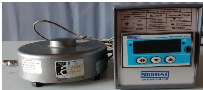
Figura 43 - Célula de carga para medição da carga de compressão aplicada
