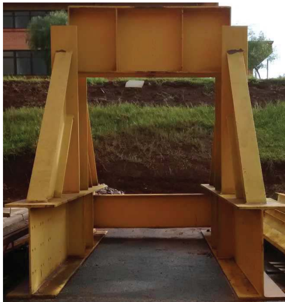
Figura 41 - Pórtico para utilização no ensaio de compressão
