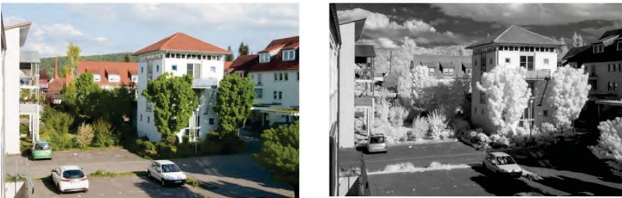
Figura 10. Comparação entre uma fotografia comum e uma imagem com iluminação NIR [38].
