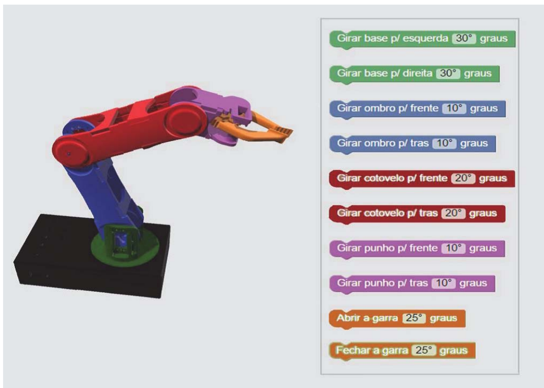
Figura 18. Braço robótico e comandos presentes na interface web.
