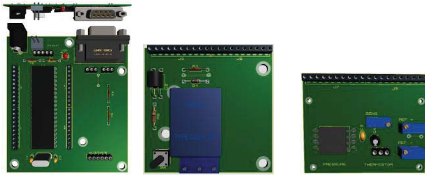
(a) Placa de controle co- (b) Acionamento de irriga- (c) Interface para os Senso- municação . ção. ções.
