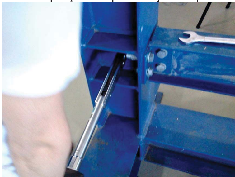
Figura 3.3–15 – Aplicação de torque aos conjuntos de parafusamento.
