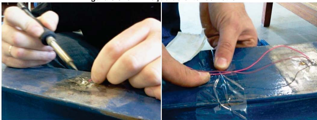
Figura 3.3–6 – Fixação do extensômetro.
