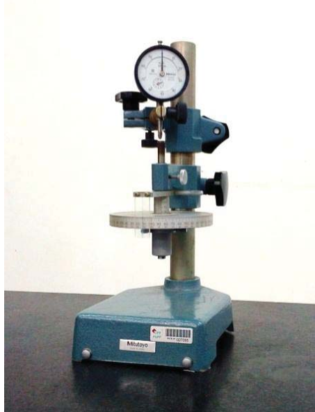
Figura 3.3–2 – Aferição do relógio comparador.
