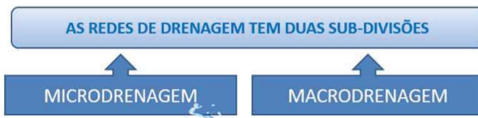
Figura 7 Composição das Redes de Drenagem
