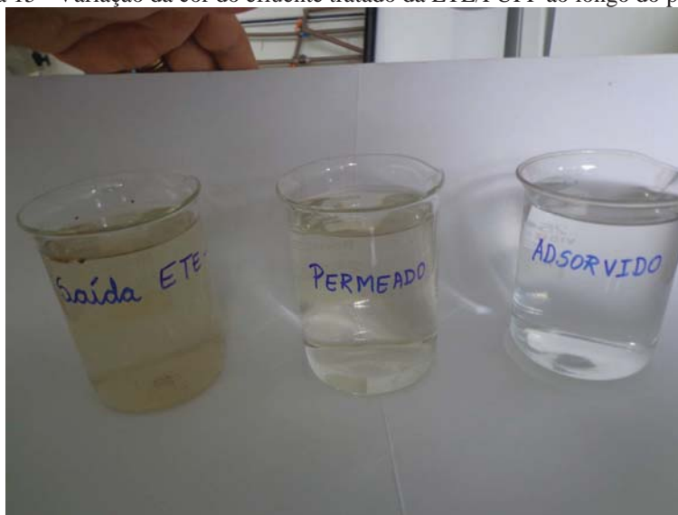
Figura 15 - Variação da cor do efluente tratado da ETE/FUPF ao longo do processo
