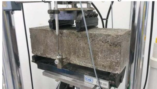
Figura 29 – Leitura dos deslocamentos: (a) Dados da prensa, (b) Dados dos LVDTs.
