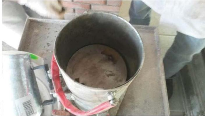
Sobre a chapa de aço foram adicionados outros pesos compatíveis com o diâmetro do cilindro, pois sem os mesmos não seria possível compactar o material na densidade estabelecida.
