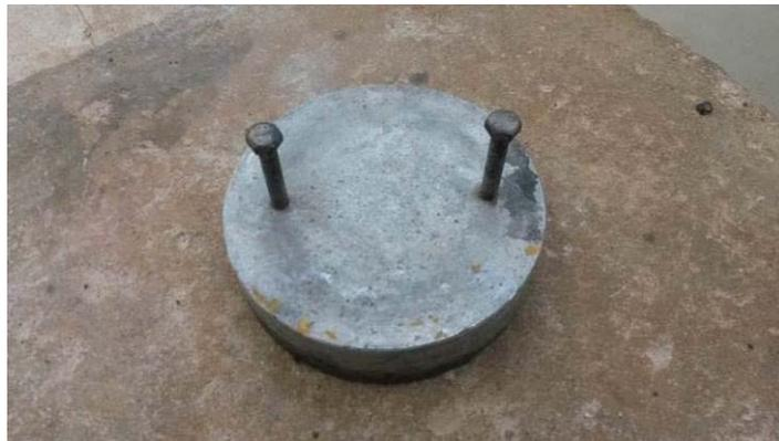
A Figura 19 mostra a chapa inserida no cilindro para a realização da compactação dos corpos de prova cilíndricos.
