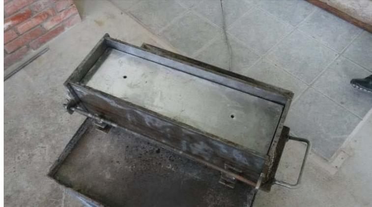
Para a compactação, as misturas foram divididas em 2 camadas dentro do molde, as quais foram compactadas separadamente. A quantidade de material a ser acrescentada em cada camada foi determinada através do volume da camada e da densidade estabelecida de 20 kN/m<sup>3</sup>. O material foi inserido no molde, sendo aplicados 50 golpes com uma haste metálica, distribuídos uniformemente sobre o mesmo.
