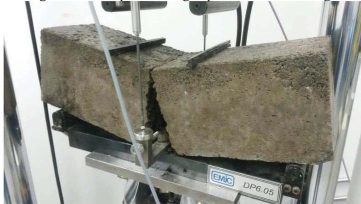
Figura 44 – Seção de uma das vigas rompidas (ensaio de fadiga).
