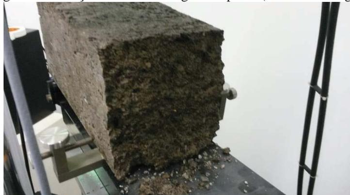
Após os ensaios, observou-se que em todas as vigas que chegaram à ruptura, a mesma ocorreu dentro do terço médio da amostra. Os resultados obtidos de vida de fadiga (número de ciclos), como também os pesos específicos aparentes secos de cada viga para as 3 relações de tensões analisadas são apresentados na Tabela 8.
