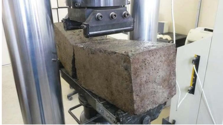
Após cada viga ser ensaiada, foi realizada a verificação do local da ruptura das mesmas, a fim de se obter a resistência à tração na flexão, como determina a norma NBR 12.142/2010. Observou-se que nas 3 vigas ensaiadas a ruptura ocorreu dentro do terço médio entre os apoios, como é apresentado na Figura 42.
