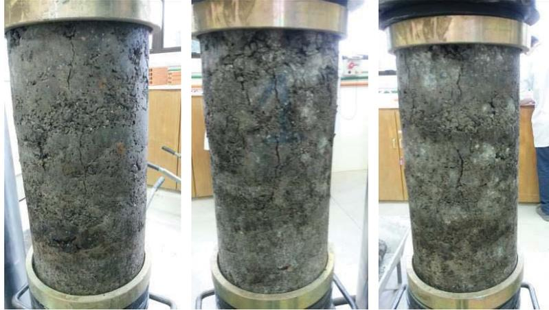
Observou-se que na maioria dos corpos de prova ensaiados a ruptura ocorreu na parte superior da amostra, provavelmente por ser a região da última camada que foi compactada.
