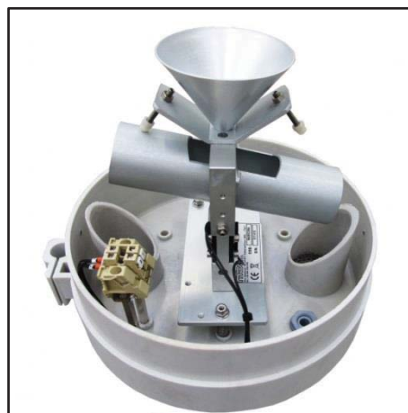
Figura 50. Modelo de pluviômetro basculante.
