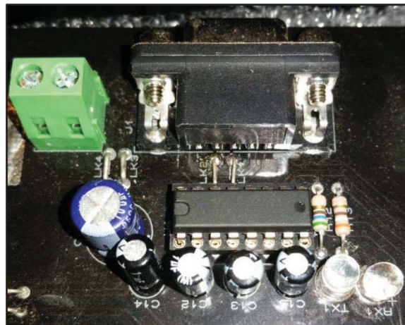
Figura 31. Montagem do circuito USART na PCB.
