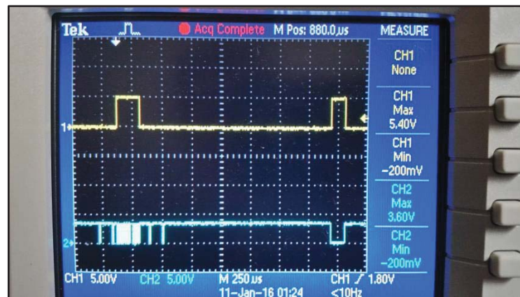
Figura 67. Forma de onda da comunicação do MCU com o SD Card.
