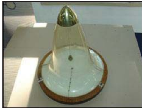
Figura 14. Inclinômetro reconstruído do modelo de Da Vinci.
