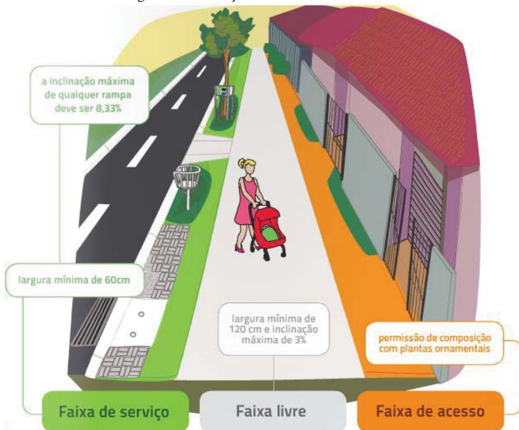
Figura 20 — Calçada sustentável e sua infraestrutura
