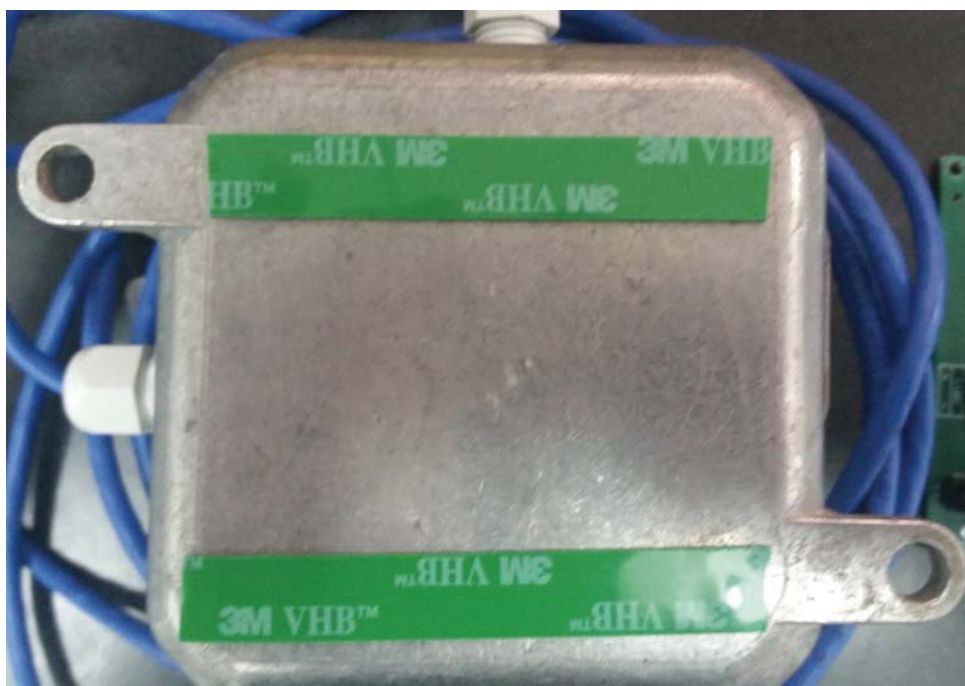
Figura 28: Fixação do SMV no shaker através de Dupla-face
