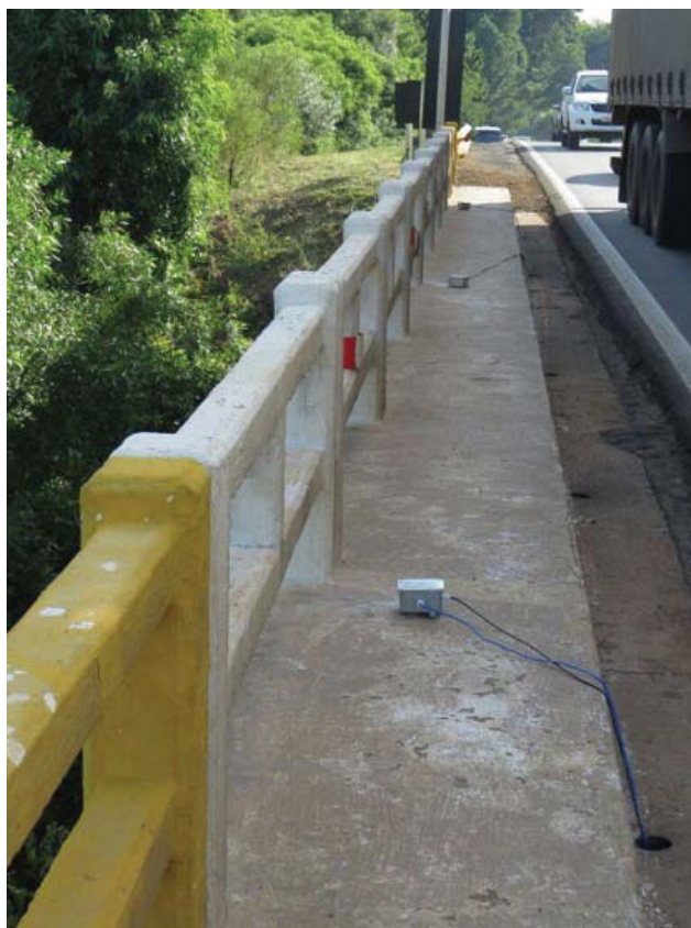
Figura 59: Disposição dos Acelerômetros ACC4, ACC3 e ACC1 no Viaduto
