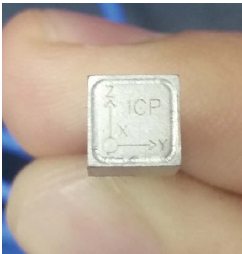
Figura 26: Orientação do Acelerômetro da PCB Piezotronics
