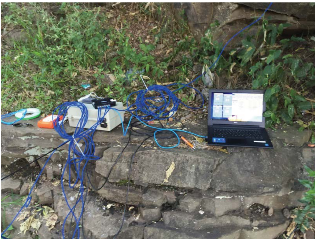
Figura 61: Sistema Instalado, com Computador, Baterias e Hub
