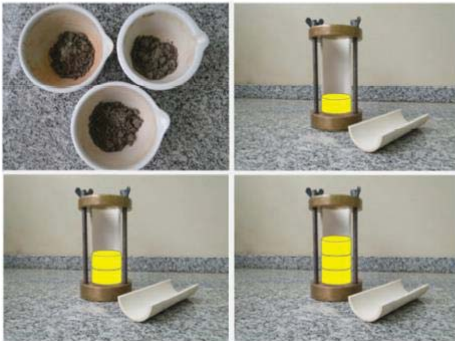
Figura 22: Procedimento de moldagem do corpo de prova
