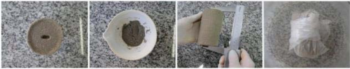
Figura 24: Preparação dos corpos de prova sem parede para os ensaios de rigidez
