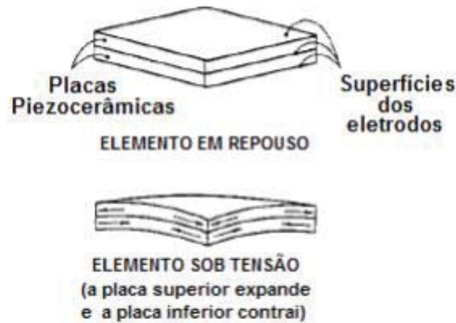
Figura 3: Transdutor piezocerâmico em repouso e sob tensão
