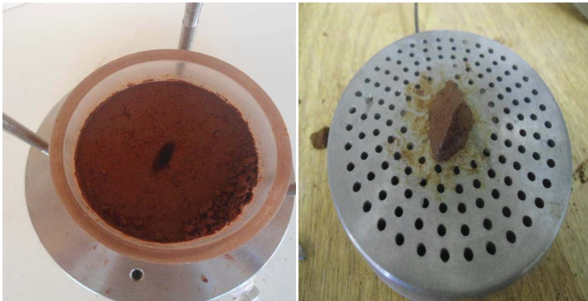
Figura 30: Sulco para introdução dos bender elements (a) e pasta de solo para fixação (b).
