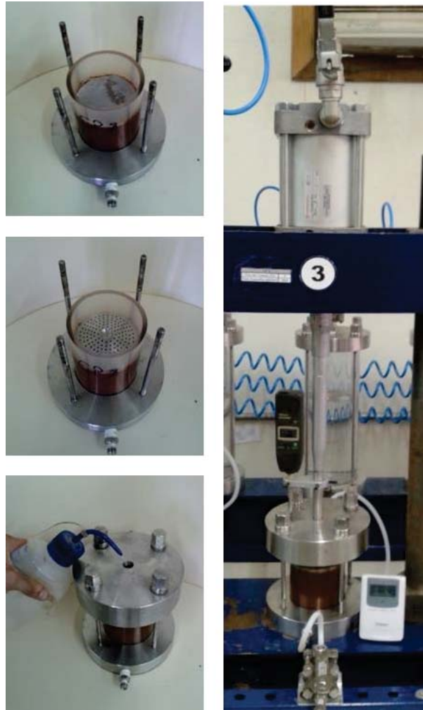
Figura 21: Procedimentos de montagem do cilindro com a amostra na câmara de ensaio
