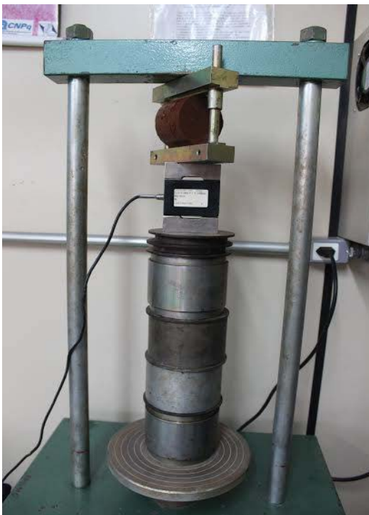
Figura 32: Execução do ensaio de resistência ao cisalhamento.
