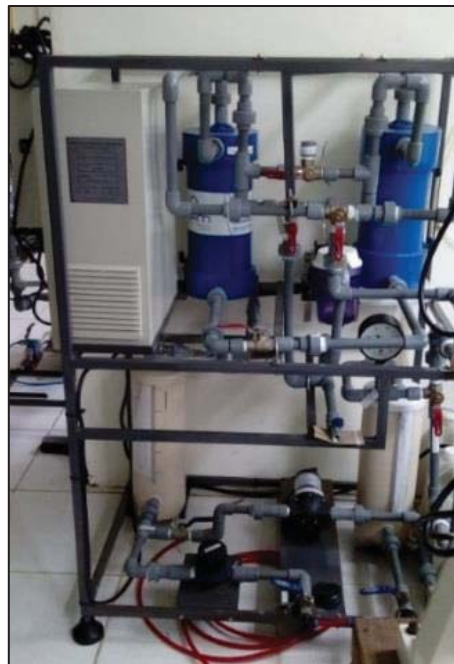
Figura 18 - Unidade piloto para Microfiltração e Ultrafiltração com membrana submersa.
