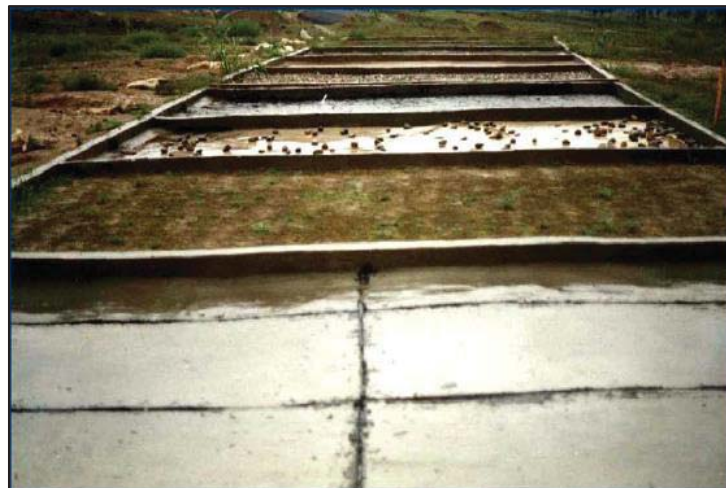
Figura 3 - Desempenho de seis superfícies para coleta de água de chuva numa região semiárida da China.
