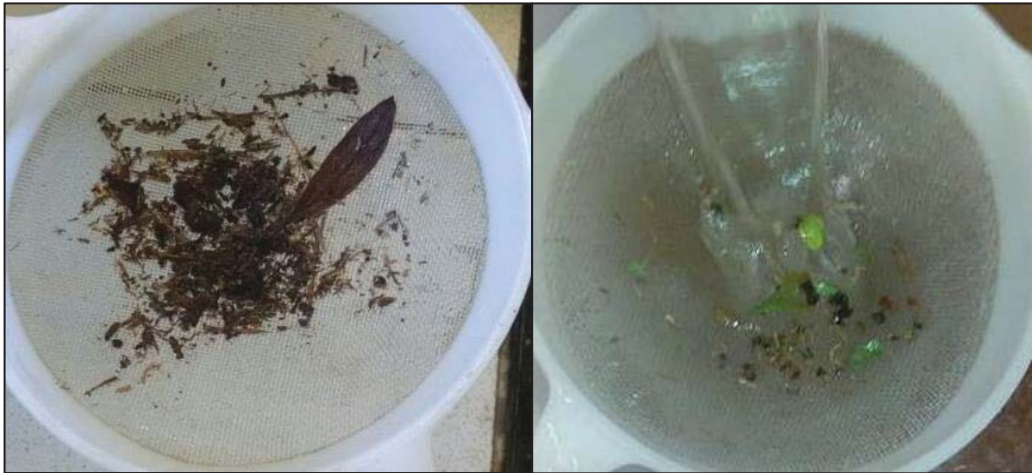
Figura 19 - Peneiramento preliminar ao processo de MF e UF.
