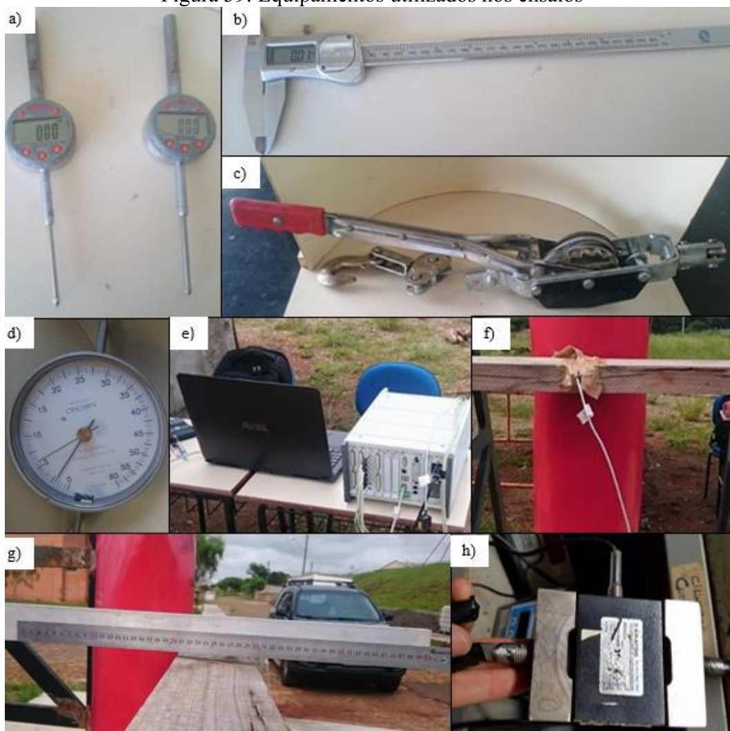
a) Relógios Comparadores; b) Paquímetro; c) Catraca; d) Dinamômetro; e) Sistema de aquisição de dados; f) Acelerômetro - Sensor instalado na estrutura; g) Régua metálica; h) Célula de carga.
