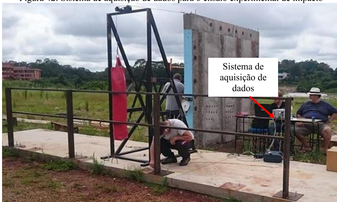
Figura 42: Sistema de aquisição de dados para o ensaio experimental de impacto
