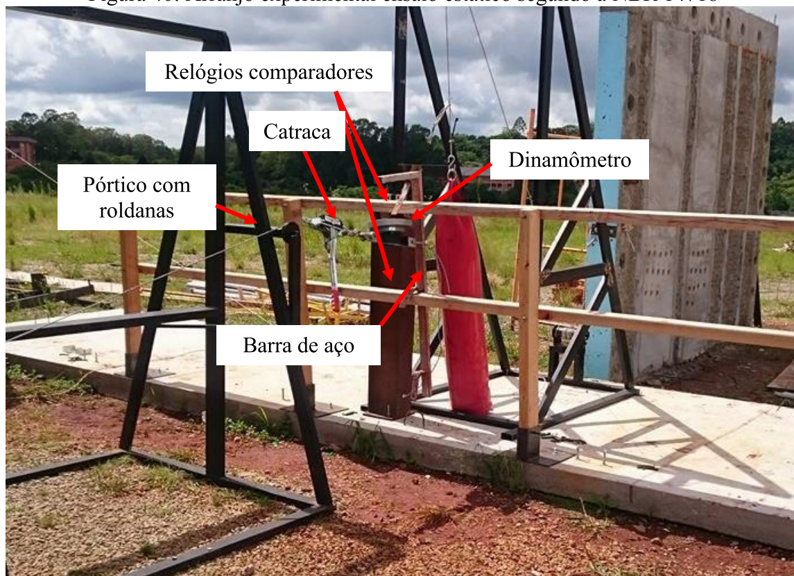
Figura 40: Arranjo experimental ensaio estático segundo a NBR 14718
