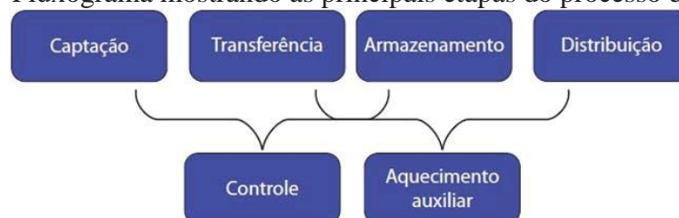
Figura 2 - Fluxograma mostrando as principais etapas do processo de um SAS.
