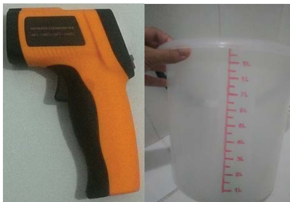
Figura 19 - Termômetro a laser infravermelho (INFRARED THERMOMETER), recipiente graduado para medir vazão
