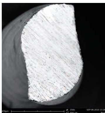
Figura 3 - Secção transversal em forma de “S” do instrumento Reciproc Fonte: Yared, G. Canal preparation with only one reciprocating instrument without prior hand filing: A new concept. 2011.
