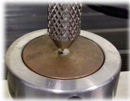
Figura 12: Teste de Pushout;
