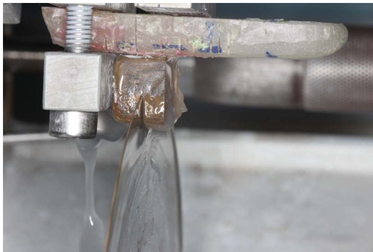
Figura 5. Corte na maior espessura do bloco.
