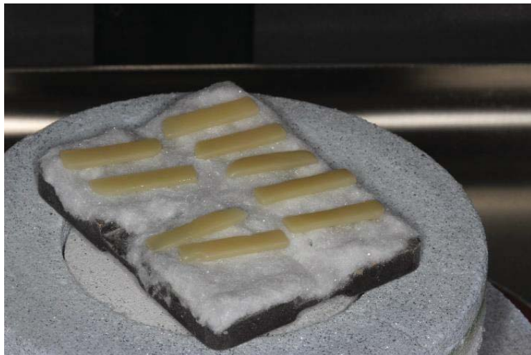
Figura 8. Corpos-de-prova imediatamente após o ciclo térmico.
