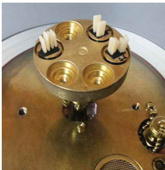
Figura 16. Barras em posição para deposição do ouro.
