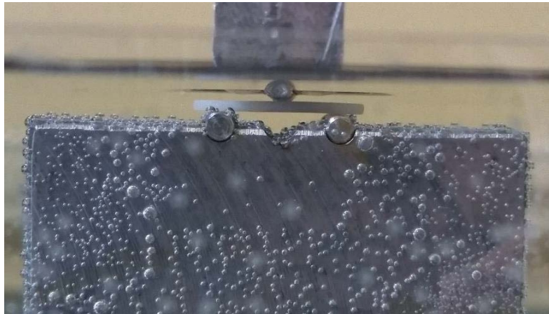
Figura 9. Corpo-de-prova posicionado no dispositivo de flexão em três pontos.
