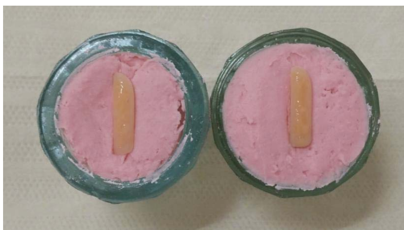
Figura 17. Condicionamento com ácido hidrofluorídrico 10% da ZLS para análise EDS.
