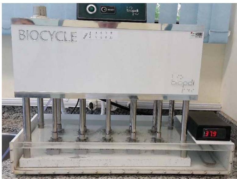
Figura 11. Máquina de ciclagem mecânica utilizada no teste de fadiga.
