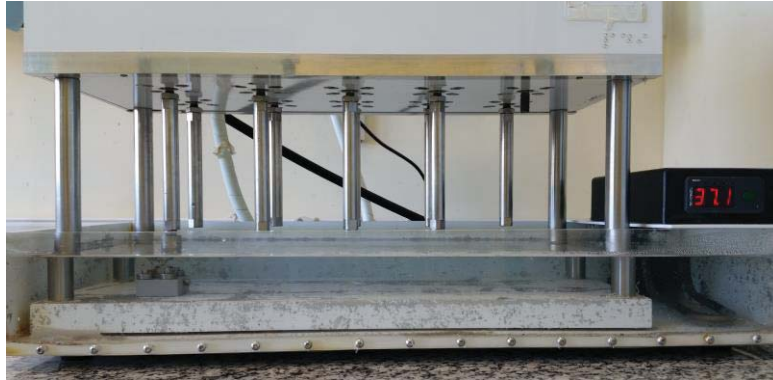
Figura 14. Um corpo-de-prova em posição para o ensaio de fadiga com a técnica staircase.
