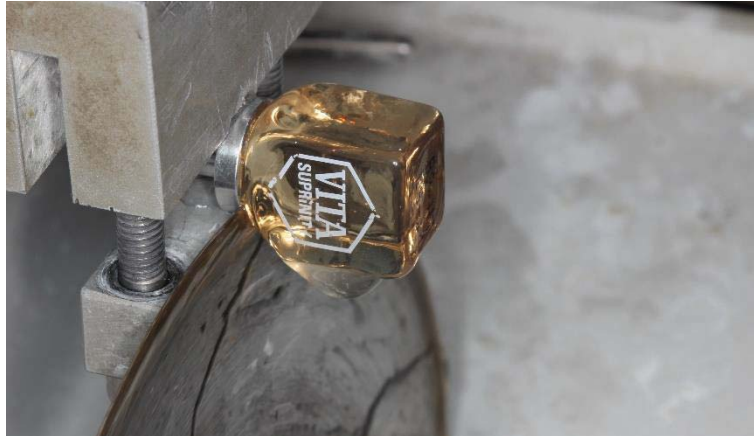
Figura 4. Corte do pino metálico do bloco.
