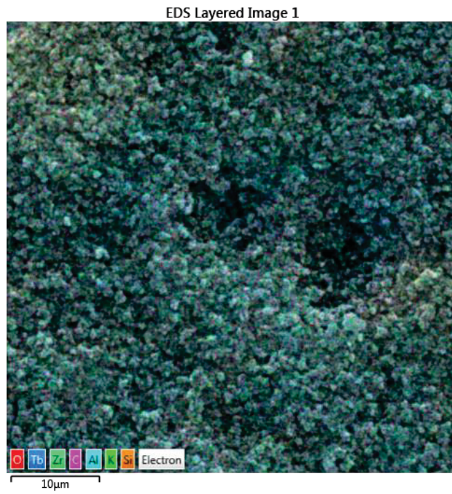
Figura 25. Espectro de uma amostra de ZLS com os respectivos componentes espalhados pela matrix.
