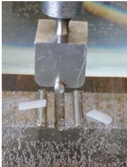
Figura 10. Fratura do corpo-de-prova após ensaio.
