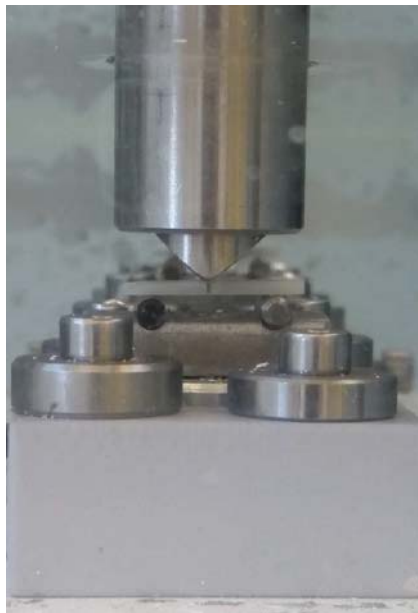
Figura 12. Barra posicionada no dispositivo com o pistão em contato na configuração de flexão em três pontos.
