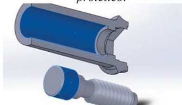
Figura 10 - Relação concêntrica entre as paredes laterais da cabeça do parafuso protético e as paredes internas da UCLA.
