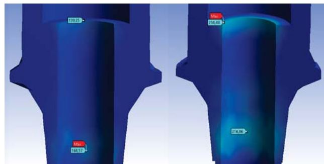
Figura 8 – Tensões máximas na UCLA de 164 N e de 234 N, respectivamente.
