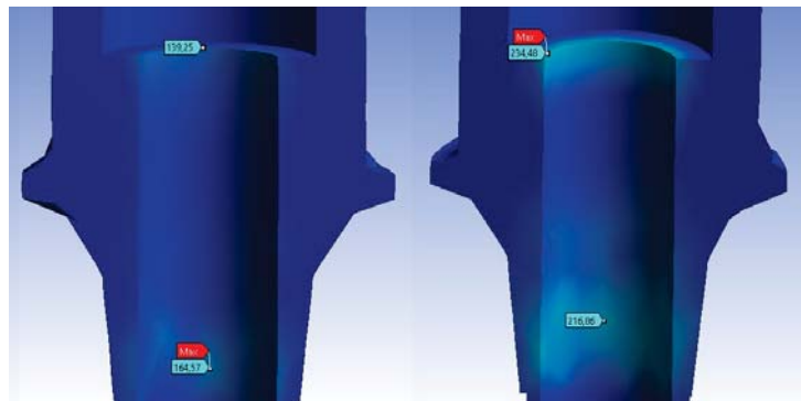
Figura 29 – Tensões máximas na UCLA de 164 N e de 234 N, respectivamente.
