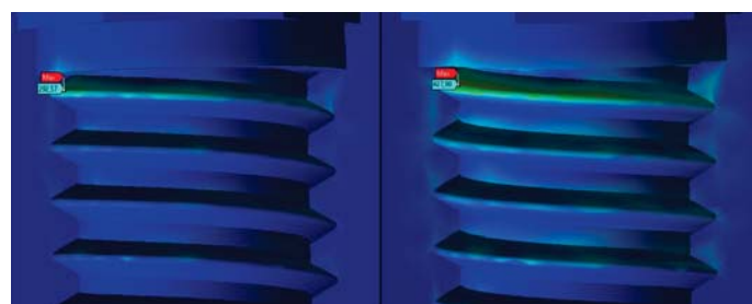
Figura 9 – Tensões máximas no implante de 292 N e de 427 N, respectivamente.
