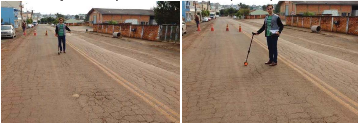
Figura 36 – Medição da extensão de defeitos na superfície do pavimento
